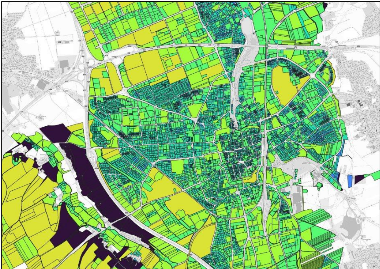
Abbildung 35: Thermische Entzugsleistung (kW) einer Grundwasserwärmepumpe für ein Brunnenpaar je Flurstück (Memmingen Stadtmitte) (Fichtner, 2025; ENANIO, 2025)
