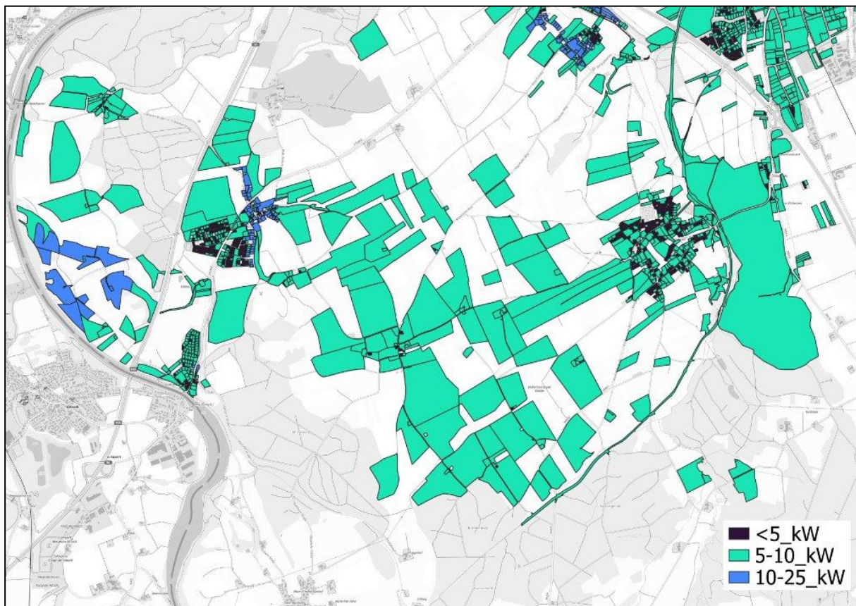
Abbildung 28: Thermische Entzugsleistung (kW) für die umsetzbare Anzahl Erdwärmesonden je Flurstück (Memmingen Süd) (Fichtner, 2025; ENANIO, 2025)
