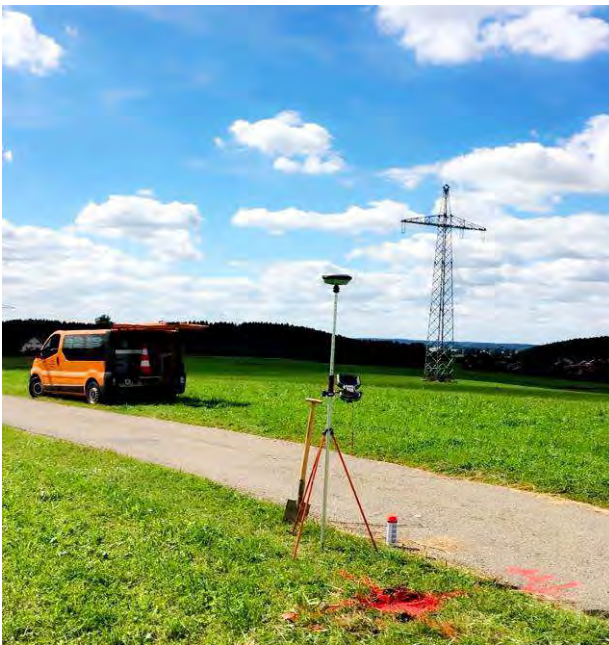
TP – Festpunktnetz, Leica GS14 - GNSS Antenne
